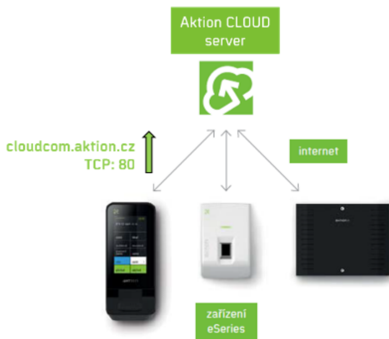
Obr. 19: Schéma zapojení pro Cloud
