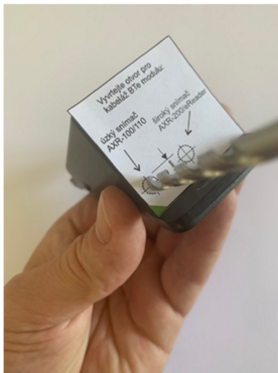
Obr. Vrtání otvoru pro úzký kryt (AXR-1xx)
