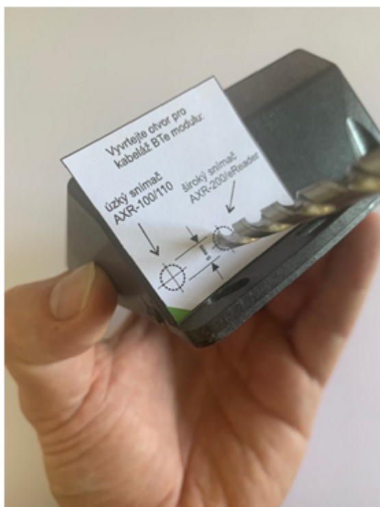
Obr. Vrtání otvoru pro široký kryt (ER, AXR-2xx)
