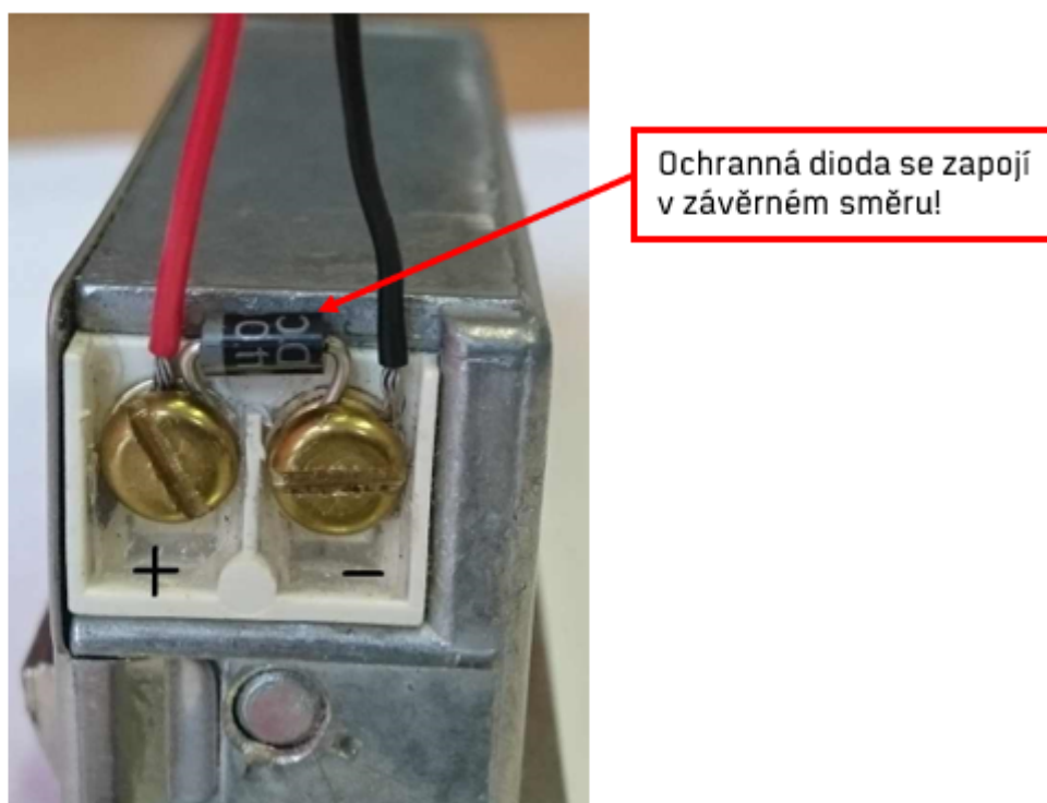
Obr. 12: Ukázka připojení diody v závěrném směru ke svorkám napájení zámku +12 V/GND
